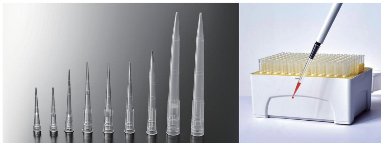
超疏水吸头表面经特殊工艺处理,具有疏水性,能显著降低液体的润湿现象,减少试剂的损失,提高移液准确度和精密性。特别适用于细胞培养,基因组学,酶反应,核酸提取和纯化,蛋白质组学,蛋白提取和纯化等实验。
