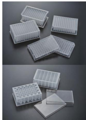
深孔板是常用的实验室耗材, 多用于 DNA 检测、高通量反应、存储和转移样品、抗体滴度检测等, 近些年作为核酸检测的主要耗材之一被大家熟知。洁特生物的深孔板采用高分子材料聚丙烯 (PP) 制成, 具有良好的化学兼容性, 适用于盛放大多数极性有机溶液、酸性和碱性等实验室液体, 且外形符合 SBS 标准, 通用于各种自动化仪器, 其中 96 圆孔版 (1mL) 适用于磁珠法全自动提取试剂盒。
