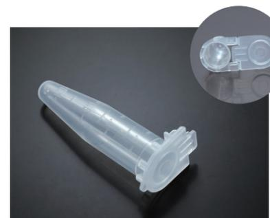
一次性易翻盖微量离心管采用优质高分子材料聚丙烯(pp)制成,主要用于少量样品的储存、运转、离心,也可配合微量移液器使用,适用少量液体的储存、运转、离心。
